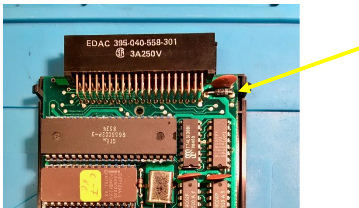
Bild 1: Lage der Schutzdiode auf dem MM II (B&P und Rebell 5.0 ähnlich)
