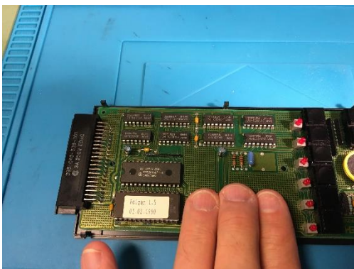
Bild 3: gleichmäßig auf den Chip drücken zum Einsetzen
