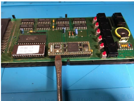
Bild 4 a,b: Reihum an den Längsseiten vorne und hinten Stück für Stück die Platine hochhebeln
