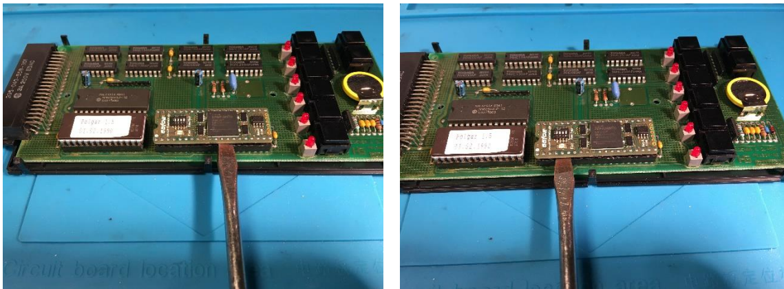
Bild 4 a,b: Reihum an den Längsseiten vorne und hinten Stück für Stück die Platine hochhebeln
