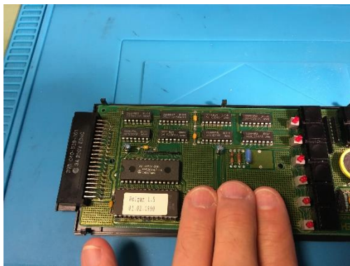
Bild 3: gleichmäßig auf den Chip drücken zum Einsetzen
